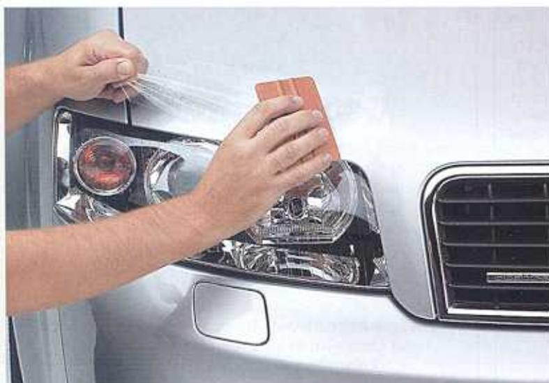
*Lackschutzfolien bewahren den Lack vor Kratzern, Steinschlag sowie Korrosion und lassen sich auch auf gewölbten Flächen auftragen.*
